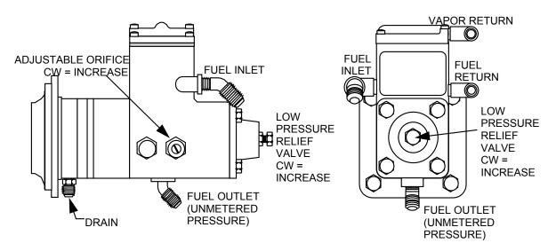
FIGURE 1 - NATURALLY ASPIRATED ENGINE FUEL PUMP
