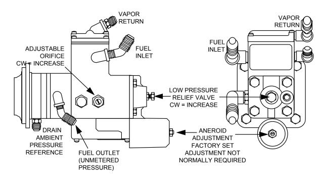
FIGURE 3 - ALTITUDE COMPENSATING FUEL PUMP
