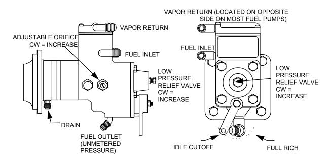
FIGURE 2 - NATURALLY ASPIRATED ENGINE (MIXTURE CONTROL EQUIPPED) FUEL PUMP
