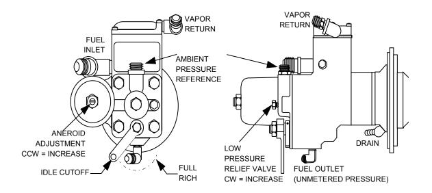
FIGURE 15 - ANEROID & MIXTURE CONTROL EQUIPPED
