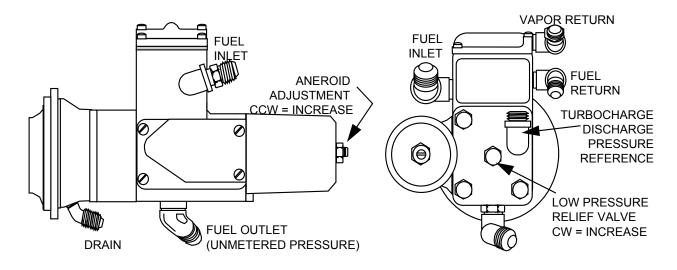
FIGURE 4 - ANEROID EQUIPPED FUEL PUMP TURBOCHARGED ENGINE
