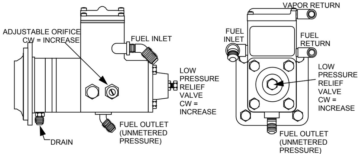
**FIGURE 1 - NATURALLY ASPIRATED ENGINE FUEL PUMP**
