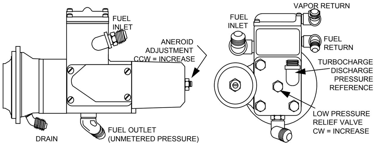
**FIGURE 4 - ANEROID EQUIPPED FUEL PUMP
