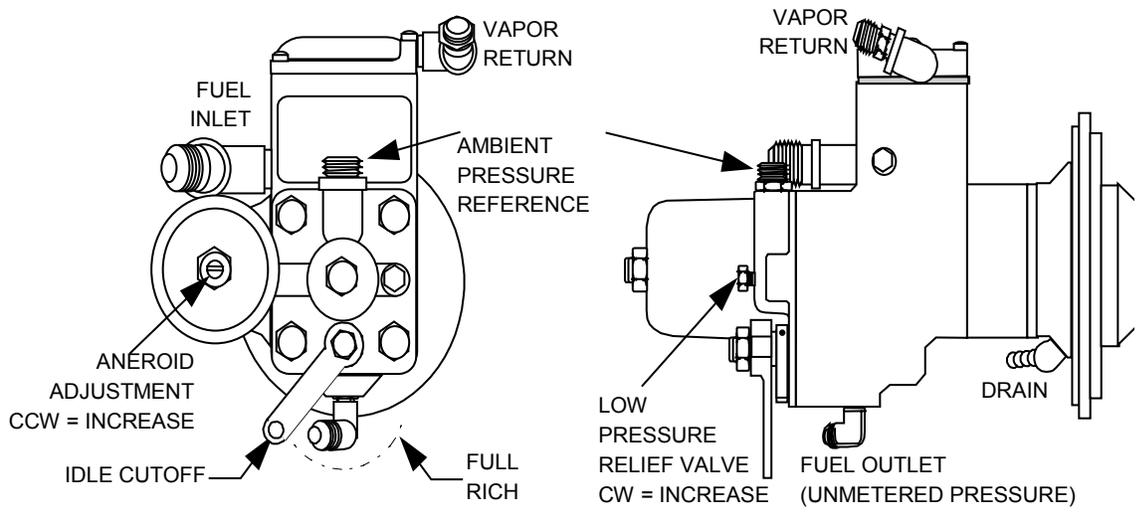
**FIGURE 15 - ANEROID & MIXTURE CONTROL EQUIPPED FUEL PUMP**
